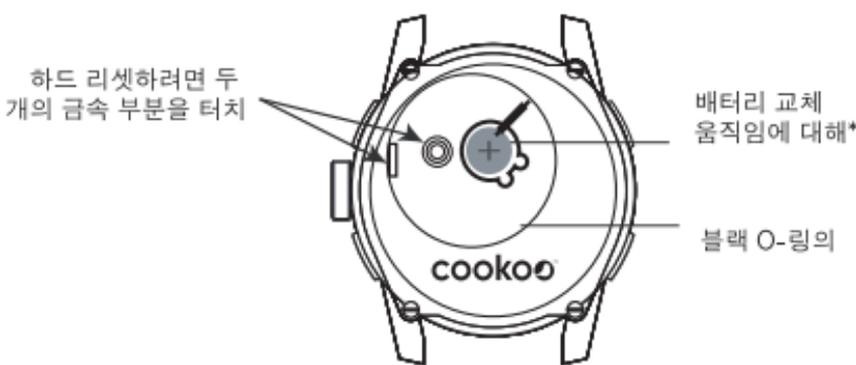
3. 새 배터리를 삽입하고 배터리 커버를 교체,(블랙 O-링의) 위치를 올바르게 지정하여 방수를 확인합니다.
