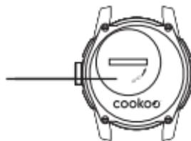
2. Retire la batería y vuelva a realizar un restablecimiento del contacto haciendo memoria durante 3 segundos con un clip de alambre entre los dos contactos de la pila del reloj.
