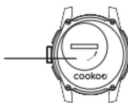
2. Togliere la batteria e sostituirla a fare un reset della memoria entrare in contatto per 3 secondi con metallo graffetta tra i due in contatto con la batteria dell'orologio.
