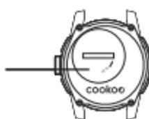
2. Entfernen Sie die alte Batterie und bewirken Sie eine harte Rückstellung indem Sie die zwei Metall-Batteriekontakte für 3 Sekunden mit einer metall Büroklammer verbinden (siehe Abbildung).
