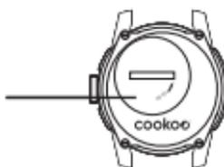
2. 取出旧电池后用一般金属回型针同时接触两个金属接点 (见下图) 3 秒进行系统重置。
