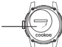
2. 古い電池を取り外して (画像参照) クリップを使用して3秒間一緒に2つの金属製のバッテリー接点に触れることにより、ハードリセットを適用する。
