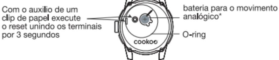
3. Insira a nova bateria e recoloca a tampa da bateria (tenha certeza de que que os anéis de vedação - O-ring - estão corretamente posicionados para assegurar a vedação do relógio - resistente a água).
